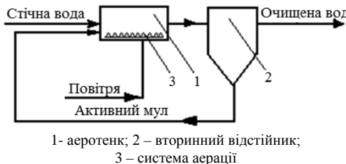
1- аеротенк; 2 – вторинний відстійник; 3 – система аерації Рисунок 3.17 – Система очищення стічних вод у аеротенках
